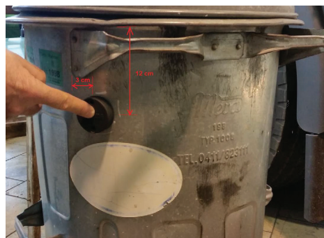
Ukázka instalace Transponderu na plechovou nádobu 1101 (obr. 2)
