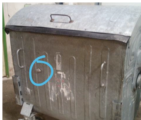
Ukázka instalace Transponderu na plechový kontejner 1100 l (obr. 3)
