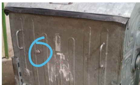
Obrázek 3 - Ukázka instalace Transponderu na plechovou nádobu 110 l
