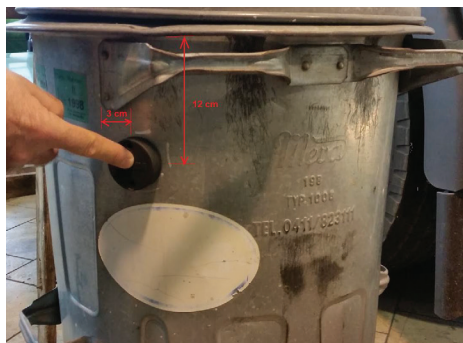
Obrázek 2 - Ukázka instalace Transponderu na plech-
